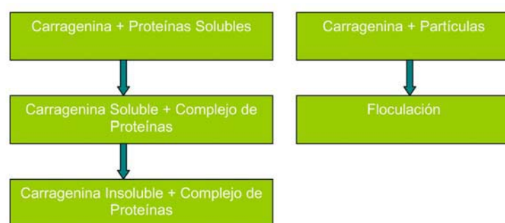
Figura 2. Mecanismo de Clarificación del Cobre — Reacciones Independientes
